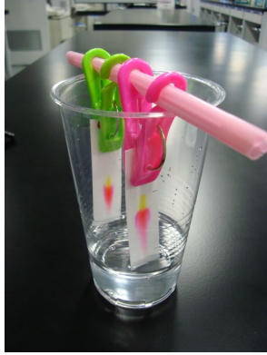
ず4 いろ色サインペンでしるしをつけた ろ紙に水をすわせるようす
