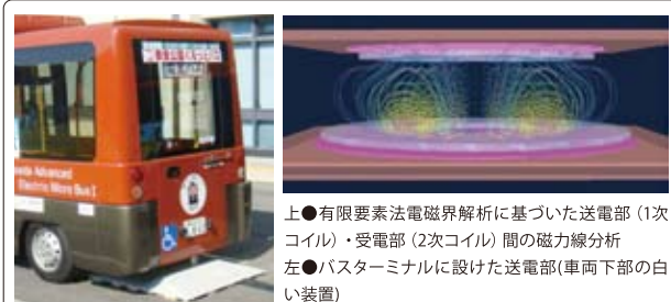
※図1: 電動車両用非接触充電装置
