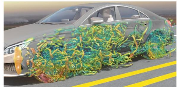
図2 路面との接触を含むタイヤの流体解析
