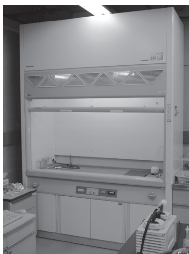
図 3-3-7. 活性炭設備付ドラフトチャンバー （上部に活性炭カートリッジ内臓）
