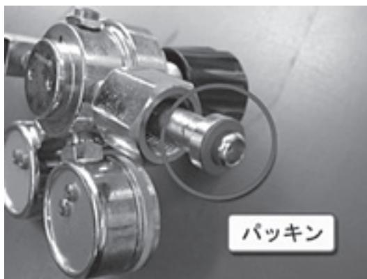
図 3-4-7. 圧力調整器の取り扱い
