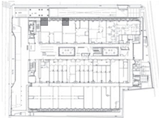
図1-4-16. 1階化学合成実験室の緊急用出口
