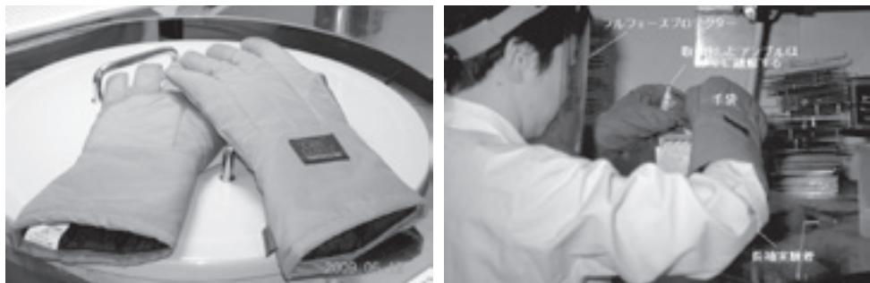
図 3-12-1. 手袋の着用と、液体窒素の取扱いの実際
