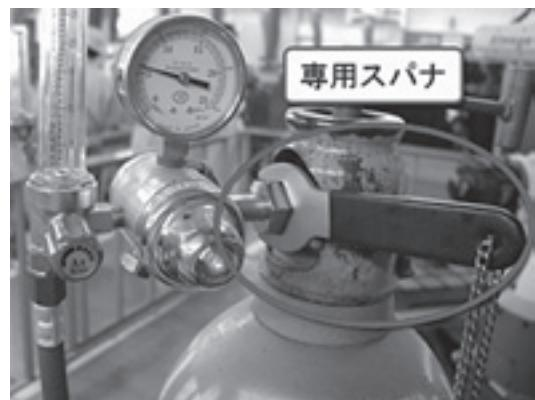
図 3-4-8. 圧力調整器のパッキン
