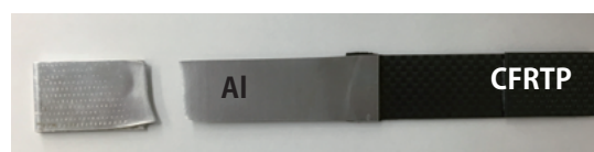
アルミニウムで破断した接合試験片 Single-lap joint specimen broken in aluminum plates
