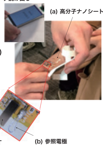
ナノシートによるpH (イオン) センサ貼り付け Fig.2 Attaching a pH (ion) sensor by nano sheets
