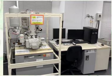
WS-011 : 電界放出型走査電子顕微鏡
