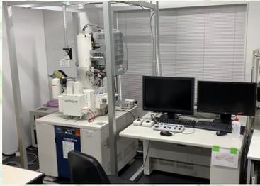
WS-012 : 電界放出型走査電子顕微鏡
