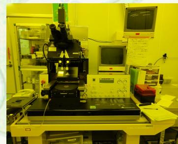
WS-014 : 紫外線露光装置 MA6
