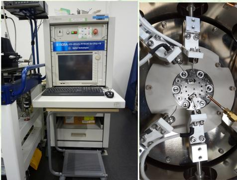
WS-022 : 高耐圧デバイス測定装置 B1505A
