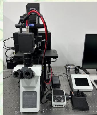
WS-031 : 共焦点レーザー走査型顕微鏡
