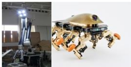
未来ロボット技術研究センター(fuRo)の遠隔作業ロボット「櫻式號」(写真左)と、脚と車輪の両方で移動が可能な「Halluc II」(写真右)。
