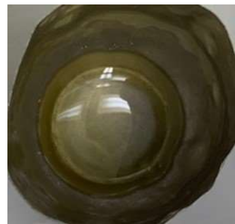
\text{Li}_2\text{B}_4\text{O}_7 によるアルカリ融解後の融解塩、 残差等溶け残りは観察されなかった。
