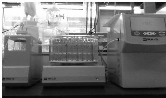
写真2 還元気化水銀測定装置
