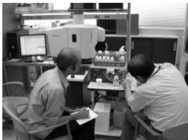
水素化物発生 ICP-AES 法にてヒ素、セレン測定
