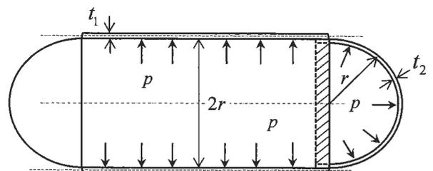
図2 内圧 $p$ が作用する圧力容器
