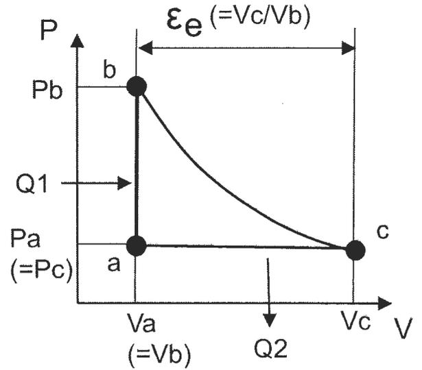
図1 アトキンソンサイクル(2→3は定容過程, 4→1は定圧過程, 1→2と3→4は可逆断熱過程)
