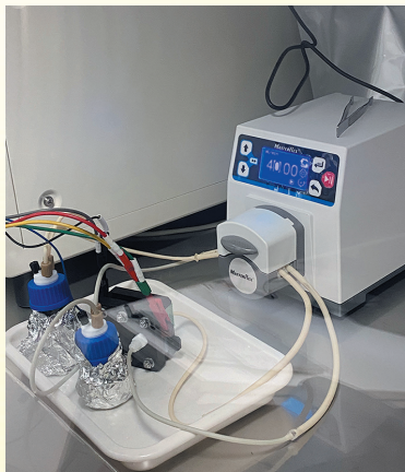
レドックスフロー電池の充放電試験
