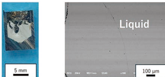
図1 \text{Nd}_2\text{O}_3\text{-Al}_2\text{O}_3\text{-SiO}_2\text{-Na}_2\text{B}_4\text{O}_7 系の急冷試料の断面写真と反射電子像
