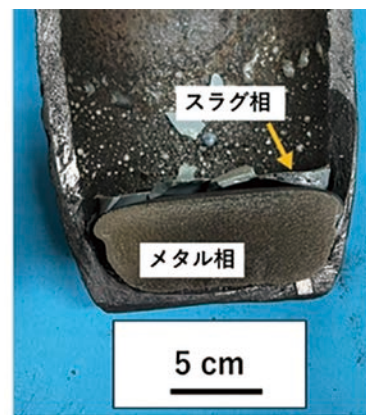
図2 100kg溶解炉でEV駆動用ロータを用いた溶解した試料の断面写真
