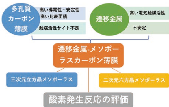
図3 CoFe合金ナノ粒子ドープ高規則メソポーラス炭素薄膜の特徴。
