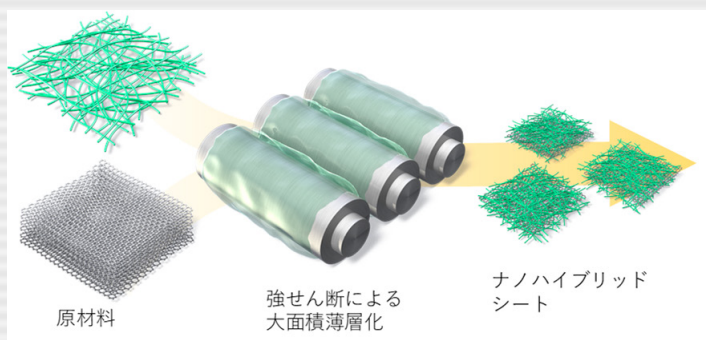
荒尾研における大面積ナノシートの作製プロセスの一例
