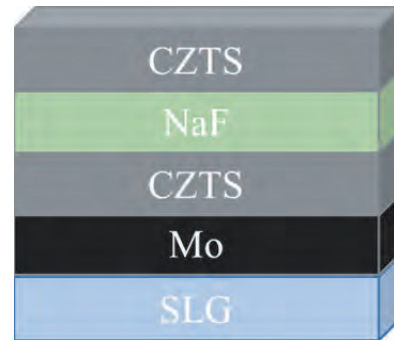
図1 NaF を光吸収層の中間部に導入したサンプルの概略図
