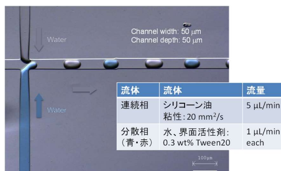
図 2 キャリア油流中に異なる液を自励振動により整列注入した実験例
