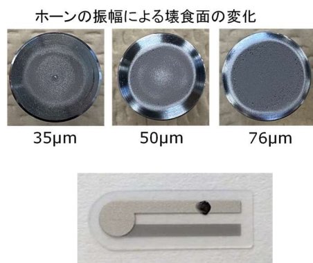
図 8 キャビテーション壊食の発生状況と崩壊力計測センサ
