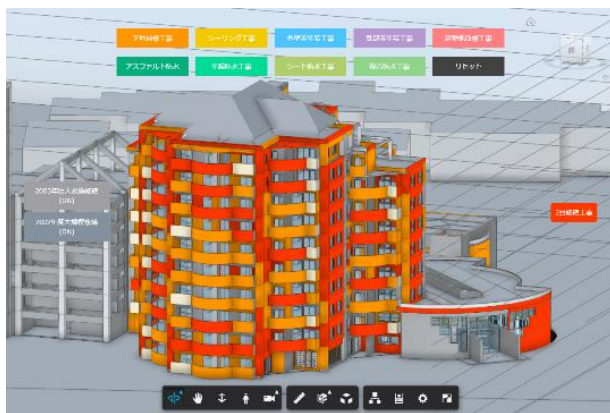
図 1 大規模修繕の履歴を記録した BIM データ
