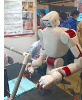
図2 Dry-AIREC による柔軟物ハンドリング学習
