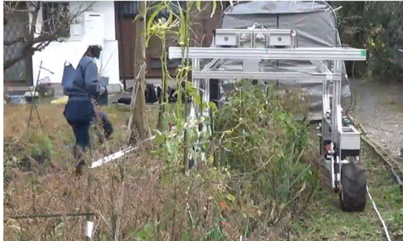
図 3 自律的な環境認識による障害物払いのけと収穫動作
