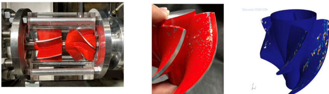
図5 固液二相流解析（CFD-DEM）によるインペラ内の固体粒子衝突挙動の予測（実験と解析）
