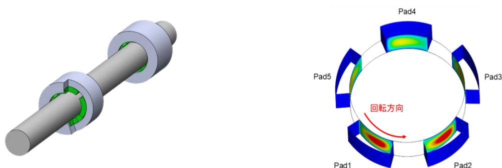
図5 ティルティングパッド軸受モデルとる謠解析によるパッド表面圧力
