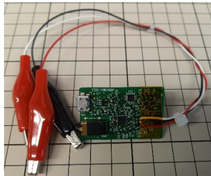
図3 (a)信号増幅基板、(b)生体電位測定・表示アプリケーション画面
