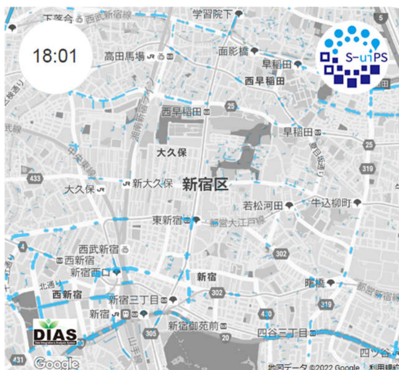
図-1 リアルタイム浸水予測S-uiPSの表示画像の一例
