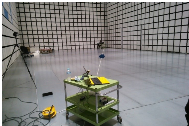
図 2 電波暗室内伝搬特性測定
