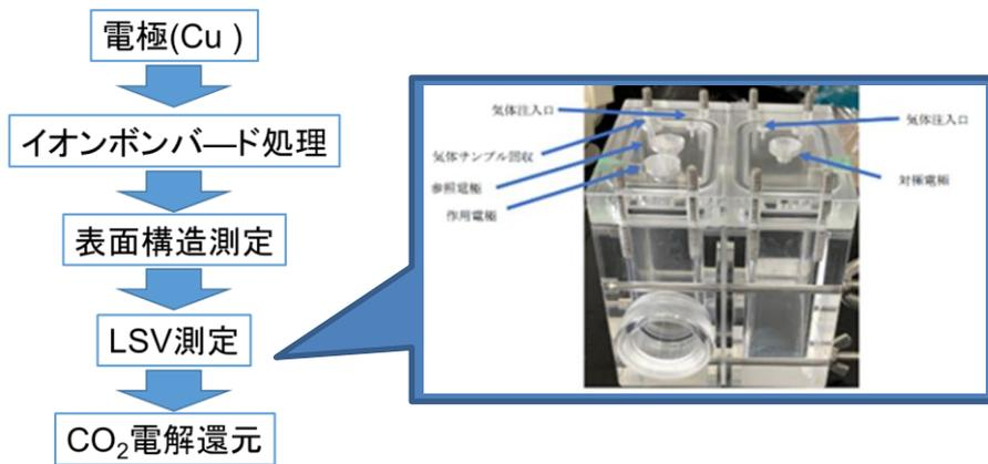
Fig.2 実験フローおよび電解セル
