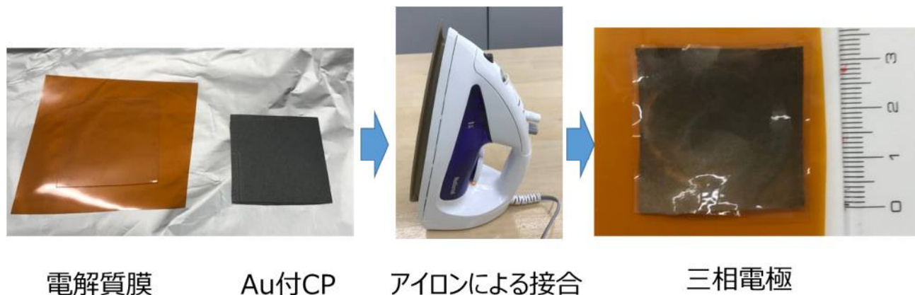
Fig. 三相電極の試作工程
