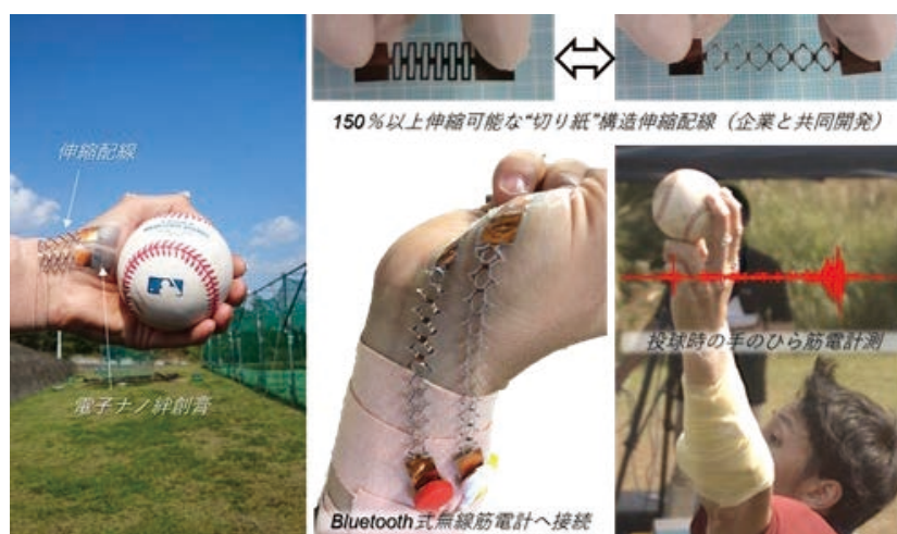
Fig. 2 電子ナノ絆創膏と伸縮配線を用いた無線筋電計測
