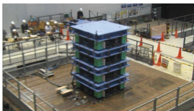
Fig. 1 センサ性能検証振動台実験（写真提供：清水建設）
