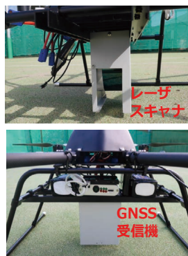
Fig. 4 複数の GNSS を搭載した UAV による三次元計測
