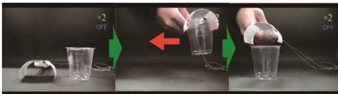
図3 印刷法による把持ロボットを用いた物体運搬の様子。
