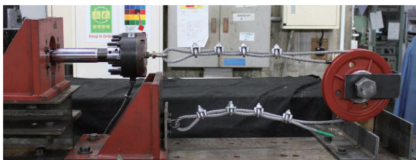
写真 1 プーリー接合部の強度試験状況
