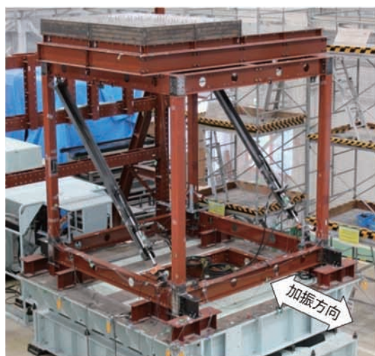
写真1 リンク式流体ダンパを設置した試験体
