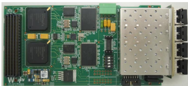
図 3: 設計した最終 12 層 IM ボード (v3.2)
