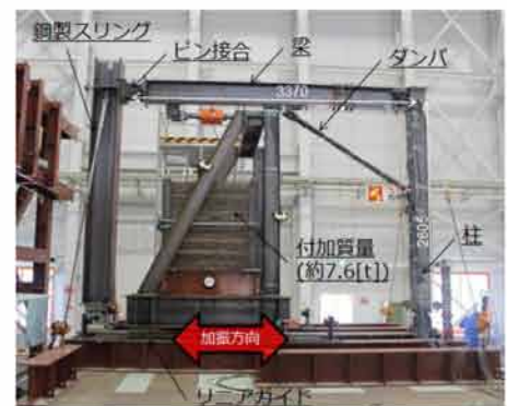
鉄骨架構の実大振動台実験の状況
