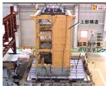
上部構造2層試験体の振動台実験の状況
