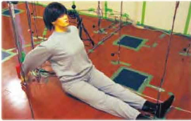
床暖房実験中のサーマルマネキン
