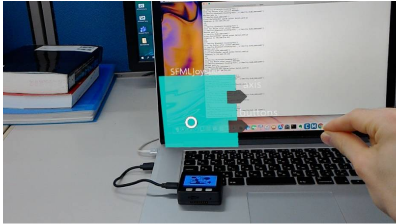
Figure 1 AR マーカーを表示した小型デバイスと，重畳表示させたソフトウェアモジュール
