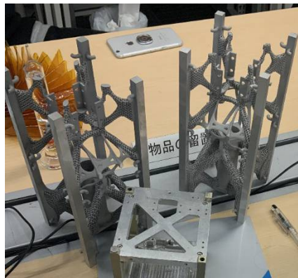
Fig.3 アルミニウム合金による金属積層法による衛星筐体
