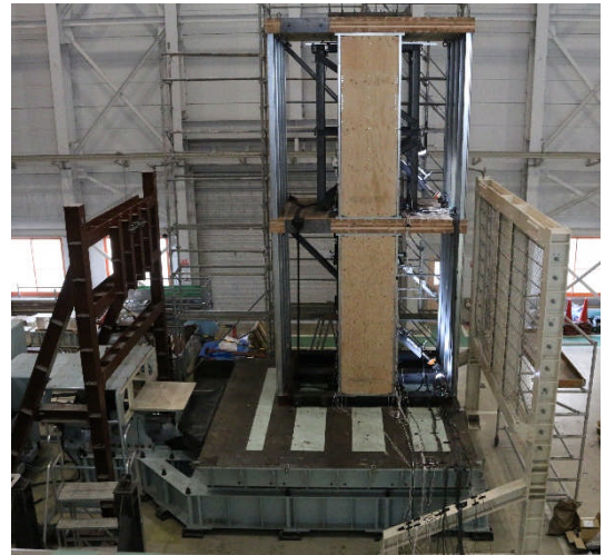
写真1 リンク式流体慣性ダンパを設置した 実寸2層フレームの振動台実験
