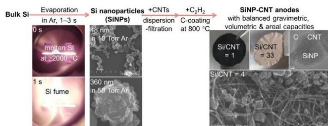
図 8. ガス中蒸発法による Si 粒子数秒合成と CNT との複合 Li 二次電池負極構築[18]
