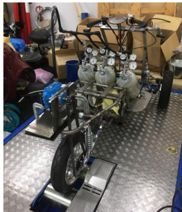
図 5 シャシーダイナモによる走行試験
