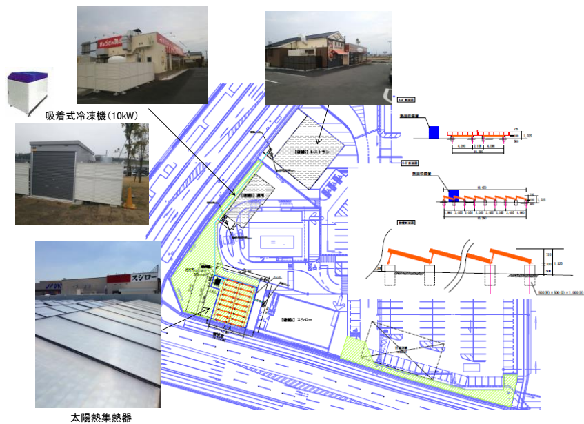
図 1 本庄スマートエネルギータウンにおける太陽熱・地中熱複合熱源システム
