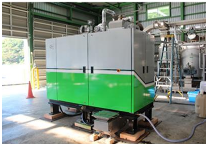
図 2 過熱水蒸気法によるトレファクション試験装置
