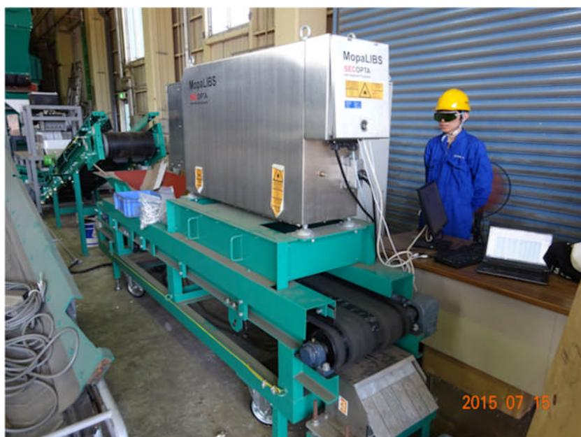
図2 世界初の産業用 LIBS ソータ@ハリタ金属
