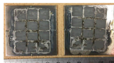
図 6 図 5 接合法で接合した Cu-Cu の破断面
