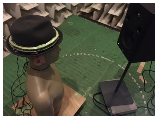
図-5 帽子型補聴システムを用いた実験
