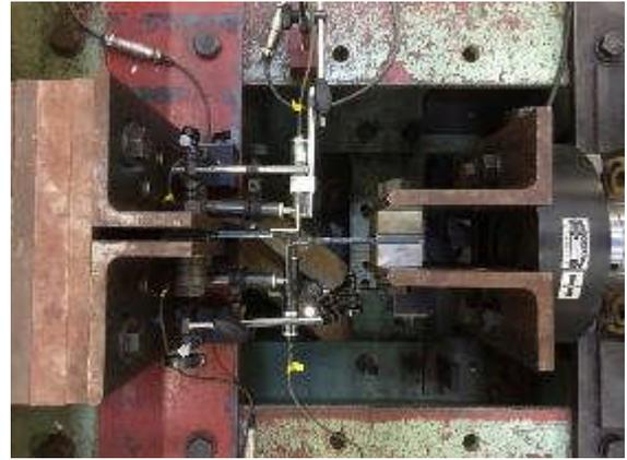
写真2 接着剤接合部の加力実験
