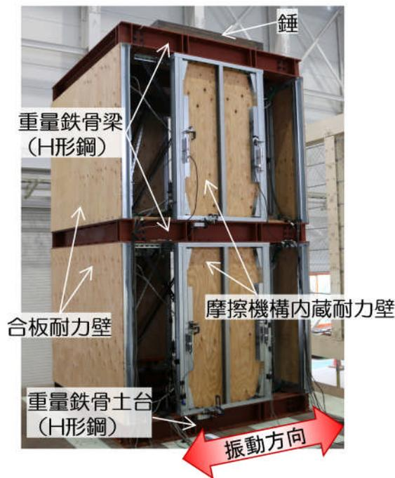
写真3 摩擦機構内蔵耐力壁を設置した
