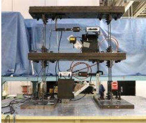
写真1 リンク式流体慣性ダンパを設置した
