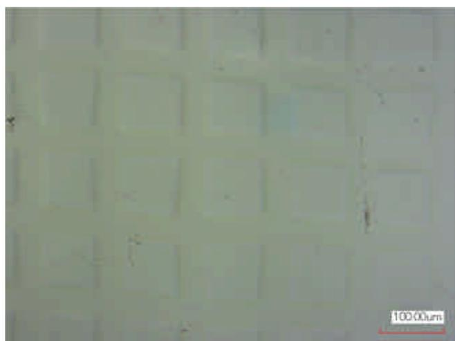
図 2 レーザー顕微鏡による表面の凸凹構造観察像
