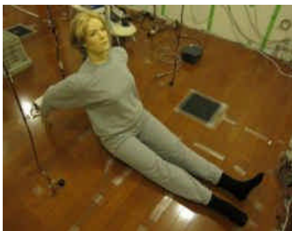
サーマルマネキンによる床暖房実験
