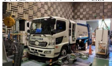
Fig. 1 燃料電池ごみ収集車のシャシーダイナモ試験の様子
