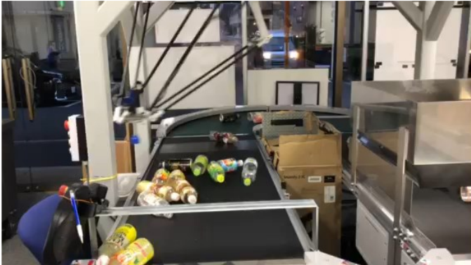
図2 AI 自動選別ロボットの実証試験（パラレルリンク式）
