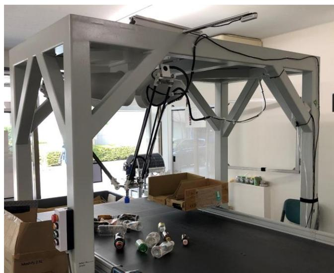
図2 AI自動選別ロボットの実証試験 (パラレルリンク式)
