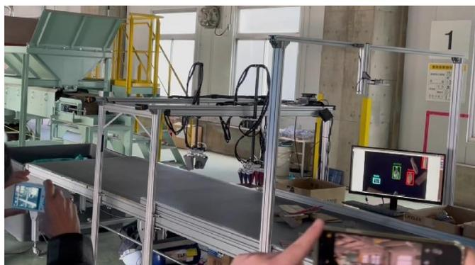
図2 AI自動選別ロボットの実証試験(アクチュエータ式)
