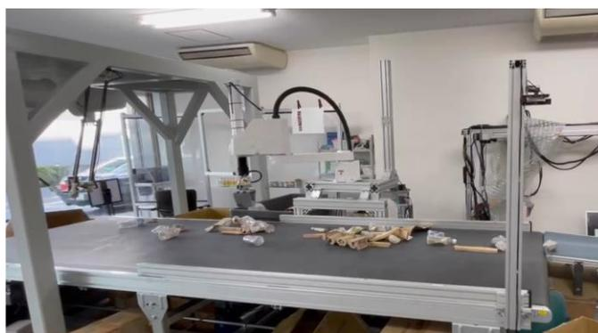
図3 AI自動選別ロボットのテスト(スカル式)
